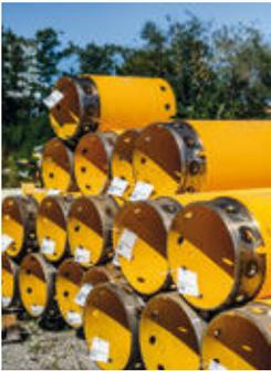
Bauer Bohrrohre werden zur Stützung von Bohrlöchern in nicht standfesten Böden eingesetzt. Sie sind speziell zur Übertragung der hohen Drehmomente und Vorschubkräfte von Bohrgeräten und Bauer Verrohrungsanlagen ausgelegt.
