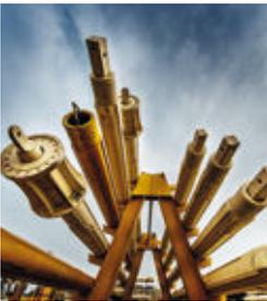
2- bis 5-fach teleskopierbar für Bohrtiefen bis 150 m bei einer Drehmomentübertragung von 120 bis 460 kNm.
